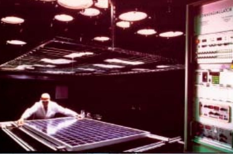
Der Sonnensimulator ermöglicht exakte Leistungsmessungen am Modul.
