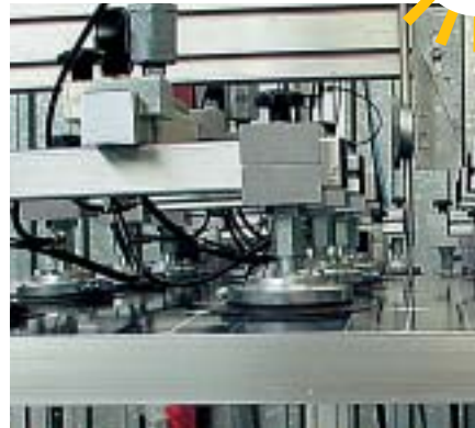
Dieser Prüfstand simuliert Belastungen durch Stürmböen und Schnee: Die Saugnäpfe übertragen Druck- und Zuglast aufs Modul.
