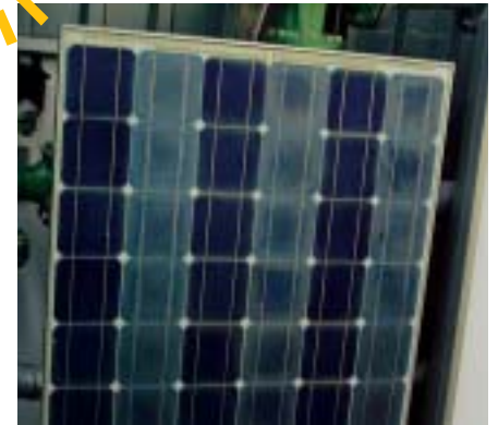
Nach dem harten Klimatest zur Prüfung der Alterungsbeständigkeit zeigen sich Farbveränderungen auf dem Sun-Technics-Modul.
